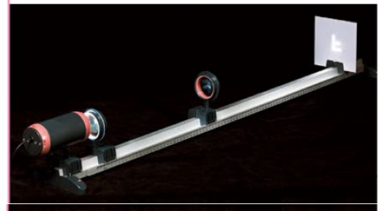
FIG. 2 Image réelle, projetée sur un écran.
